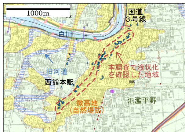
熊本市南区で確認した帯状に広がる液状化地区と地形分類の関係(国土地理院 治水地形分類図に加筆して作成)
