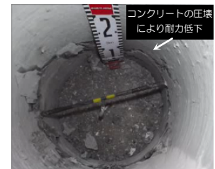
SC杭(コンクリート充填なし) 実験写真 [変形δ=-12mm時点]
